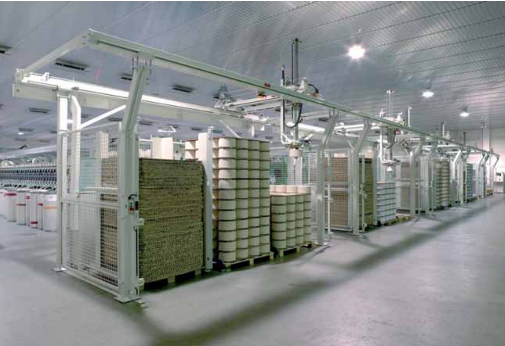
► VISTA GENERAL DE UNA INSTALACIÓN DE PALETIZACIÓN A LA SALIDA DE MÁQUINAS OPEN-END ► GENERAL VIEW OF A PALLETIZING INSTALLATION AT THE EXIT OF THE OPEN END MACHINES
