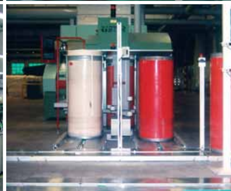
► INSTALACIONES AUTOMÁTICAS DE TRANSPORTE DE BOBINAS Y DE TRANSPORTE DE BOTES
