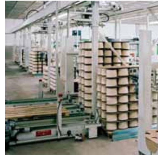
► DETALLE DEL CARRO TRANSFERIDOR DE PALETS EN UNA INSTALACIÓN DE PALETIZACIÓN AUTOMÁTICA ► DETAIL OF THE PALLETS TRANSFER CART IN A AUTOMATIC PALLETIZING INSTALLATION
